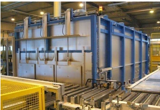
Anwärmofen für Räder vor dem Drückwalzen
