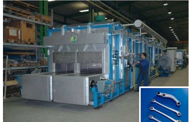
Erwärmen von gegossenen Fahrwerksteilen für den nachfolgenden Schmiedeprozess (COBAPRESS®-Verfahren), Beladeseite Durchsatz 2,5 t/h, offen Erdgas-beheizt
