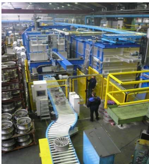
Vergüteanlage für geschmiedete Aluminium-Räder, direkte Verkettung mit dem Drückwalz-Prozess
