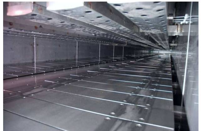
Innenansicht des Ofens mit Jet-Heating Düsenbalken, Zweireihige, getrennte Fahrweise
