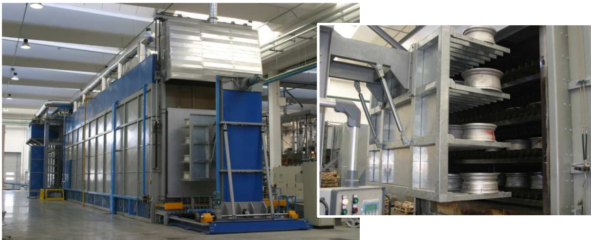
Wärmebehandlungsanlage zum Lösungsglühen und Warmauslagern von gegossenen Leichtmetallrädern
