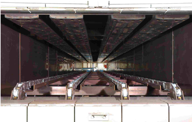
Innenansicht des LGO, zweireihiger, innenliegender Kettentransport
