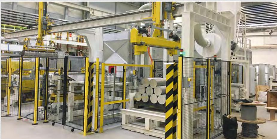
Bolzenerwärmung komplett mit Handling
